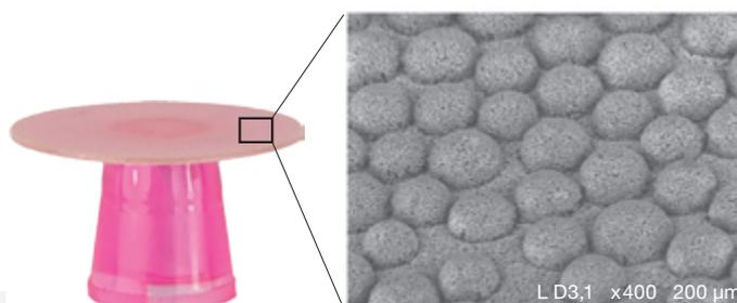
Die roten Super-Snap X-Treme Scheiben weisen erstmals eine innovative 3-D-Beschichtung auf. Zwischen den homogen verteilten Halbkugeln aus Aluminiumoxid-Partikeln kann sich der Politurabrieb ablagern und wird nach außen transportiert. Ein Zusetzen oder Verklumpen der Scheibenoberfläche und Sekundärkratzer durch Polierstaub werden so sicher verhindert.
